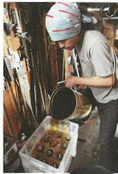
上／天ぷら油はボリタングで一度ゴミを濾過し、上澄みのいい油を再度、目の細かいスポンジ状のこし器に通してから使う。右／ハンドル横には燃料切り替え用のスイッチがある
